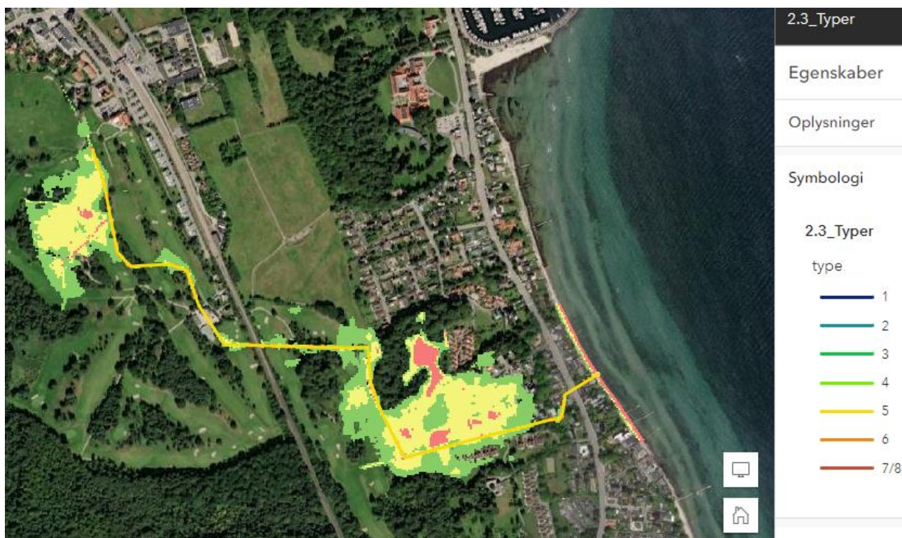
Figur 15. Ulvemoserenden løber igennem Rungsted by og har sit udløb i Øresund. Store dele af vandløbet er rørlagt eller har meget dybe nedstik.
