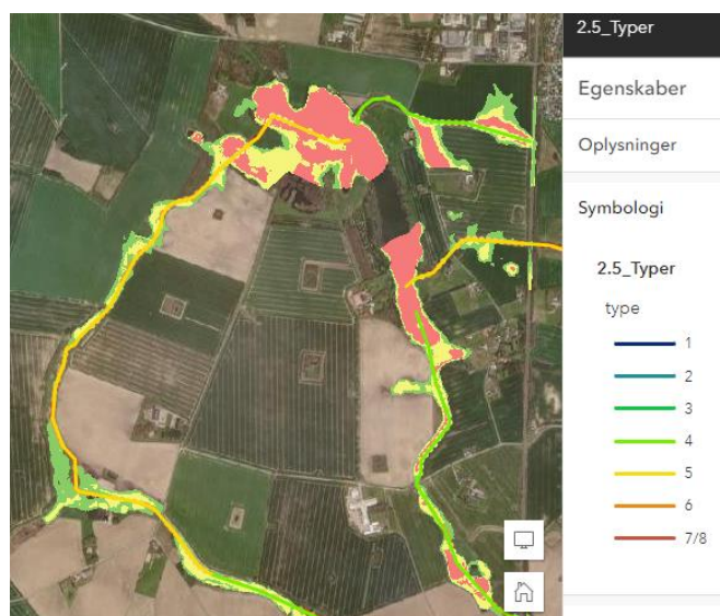
Figur 26. Valmosegrøften er et type 5 vandløb med dybt nedstik, kanalisering og stor risiko for negative konsekvenser ved indsatser i vandløbet.
