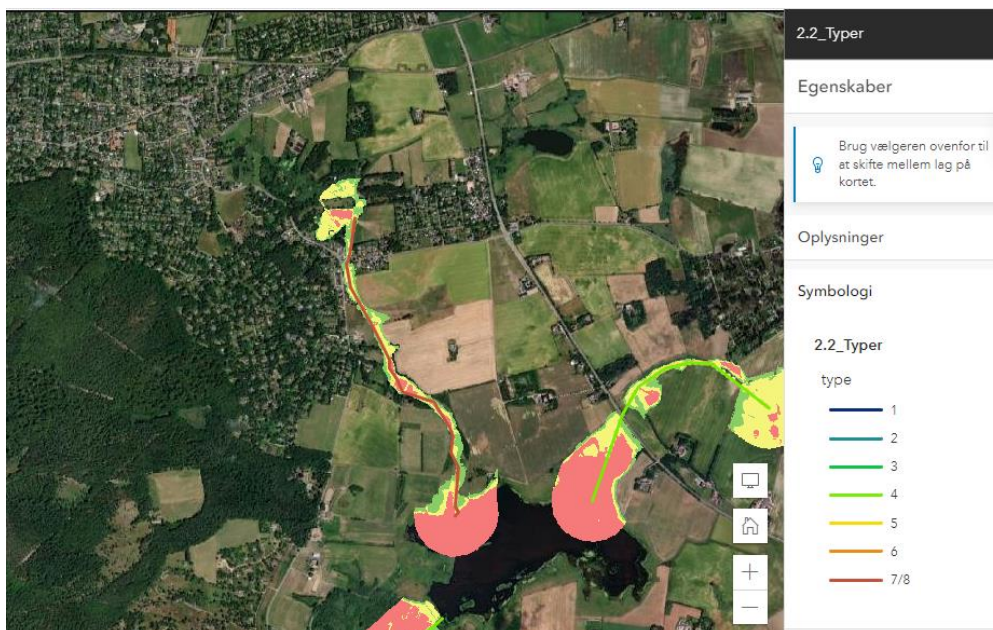
Figur 9. Type 7/8 vandløb dækker over rørlagt vandløb som i dette tilfælde også har ringe eller ingen slyngning. De røde gule og grønne farver omkring vandløbet er risikovurderinger for vandafledningsmæssige forhold hvis der skulle ske en ændring i driften eller hvis der skulle foretages naturgenopretning på strækningen.
